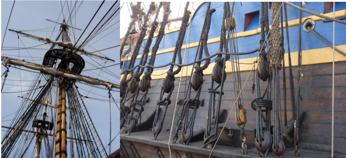
Figur 17. Detaljer på Götheborg III för att illustrera de olyckliga sjömannens arbetsplats före fallet: t. vä. storvant och märs, samt, nära övre kanten av bilden, bramsalningen: det var ända där uppe, som Olof Westerberg satt. T. hö. storvantets fäste på utsidan av fartyget. Komplicerad, gedigen konstruktion. Se även figur 14. Foto HK.
