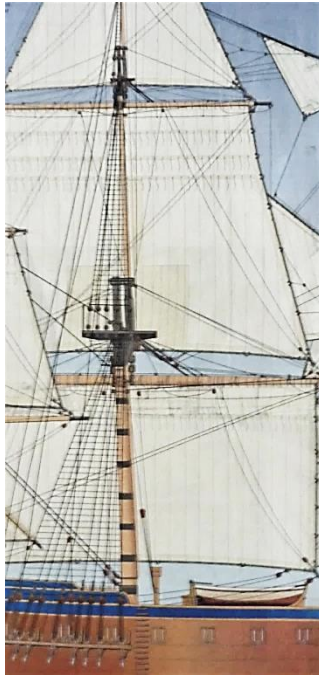
Figur 14. Stormasten på Götheborg III. Storvantet, med sina vevlingar som en stege upp till mäsens och salningen. Eselhuvudet ett par cm därovan på bilden. Salningen och eselhuvudet syftade till att hålla ihop en mastdel med nästa ovanför, vilka gick 2-3 meter omlott: en enda mast ända upp till toppen skulle bli för tung att hantera, varför man vid den här tiden på fartyg av den här storleken hade en undre del (mast) och därovan två stänger; märsstång och bramstång. På däck för om stormasten ses en chaloup. Se även figur 17. Från GP 2003.
